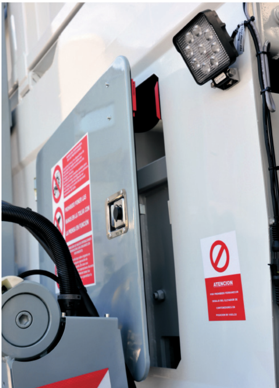
COMPUERTA DE INSPECCIÓN Y DE ACESO A TOLVA PERFECTAMENTE ESTANCAS
