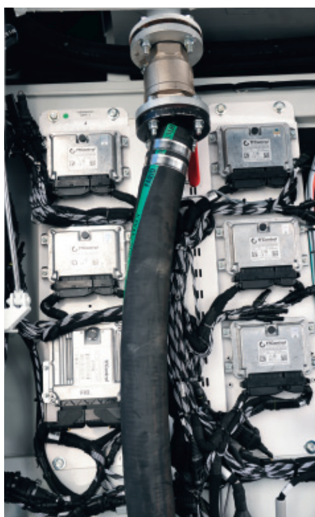
TARJETAS ELECTRONICAS DE TIPO "AUTOMOTIVE" – INTERCAMBIABLES CON UNA FÁCIL PROGRAMACIÓN
