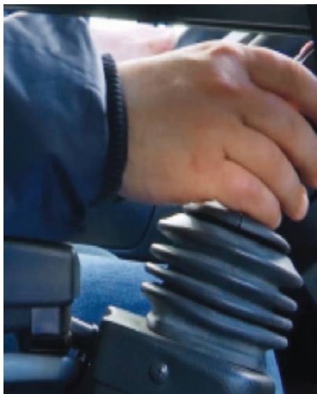
APOYABRAZO REGULABLE Y JOYSTICK DE TIPO "CAPACITIVO"
