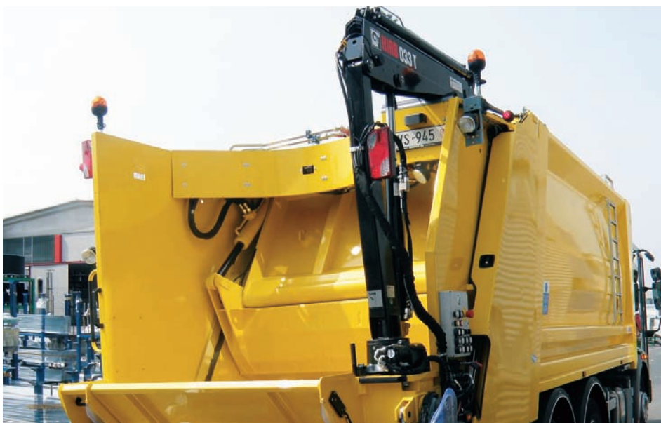
GRUE POSITIONNÉE SUR LA PORTE ARRIÈRE
