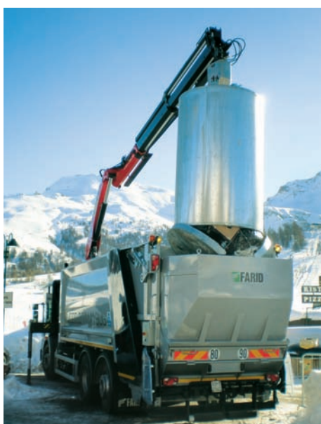
GRUE POSITIONNÉE À L'ARRIÈRE DE LA CABINE
