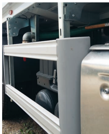
APPLICATION DE BARRES LATÉRALES ANTI-ENCASTREMENT SUR LE LONGERON
