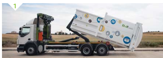
SISTEMA DE TAPA MÓVIL DE LA CAJA, CON APERTURA Y CIERRE SINCRONIZADOS AUTOMÁTICAMENTE CON EL ELEVADOR
