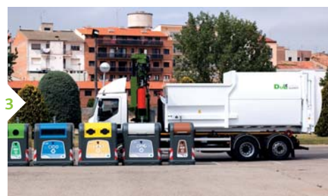
PINZA ESTÁNDAR PARA CONTENEDORES CON GANCHO SEGÚN LA NORMATIVA EN13071
