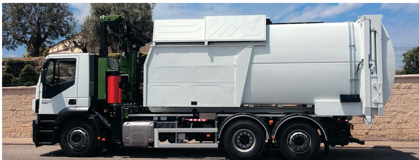
SISTEMA DE TAPA MÓVIL DE LA CAJA, CON APERTURA Y CIERRE SINCRONIZADOS AUTOMÁTICAMENTE CON EL ELEVADOR
