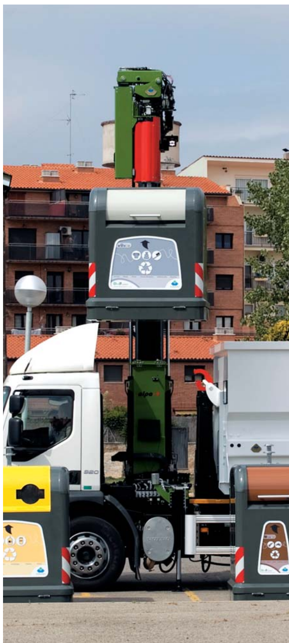
ALPA12 PERMITE OPERAR CON CONTENEDORES SITUADOS A AMBOS LADOS
