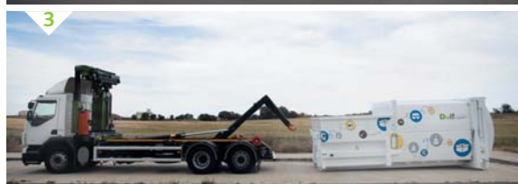
CARROCERÍA DESMONTABLE MEDIANTE EL SISTEMA HOOK LIFT
