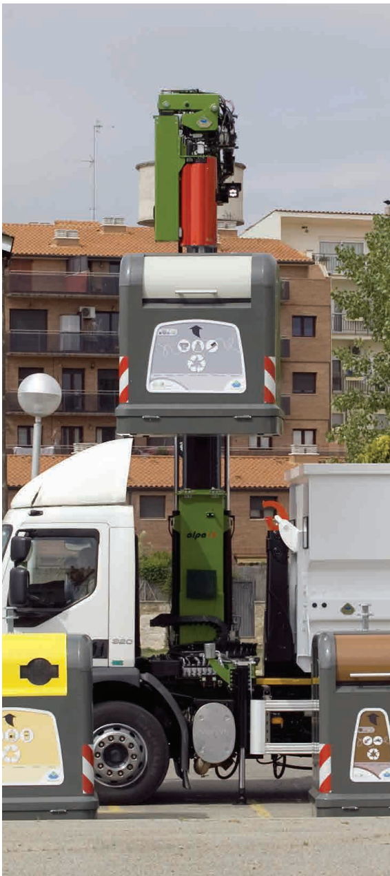
L'ELEVATORE ALPA 12 CONSENTE LA PRESA DEI CONTENITORI DA AMBOS I LATI
