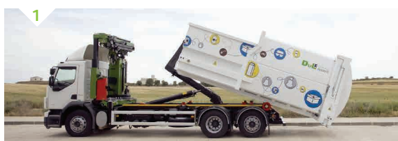
SISTEMA DI COPERTURA MOBILE DEL CASSONE, CON APERTURA E CHIUSURA SINCRONIZZATA IN AUTOMATICO CON L'ELEVATORE
