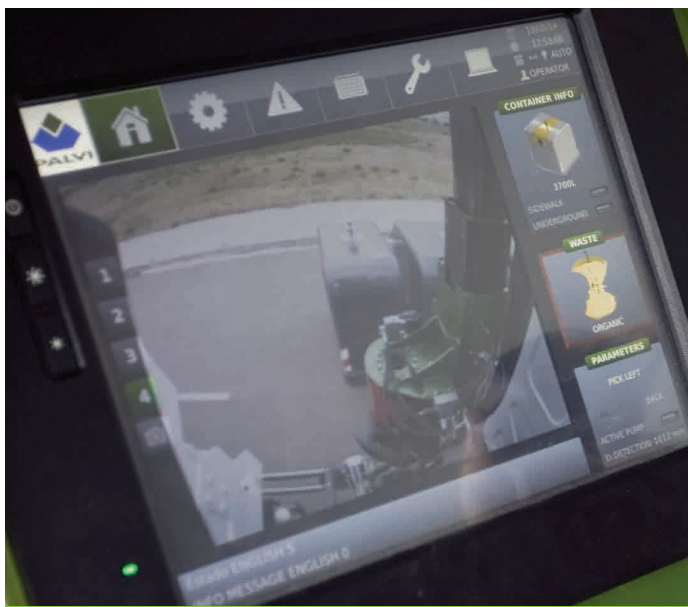
TELECAMERA DI CONTROLLO CONTENITORE
