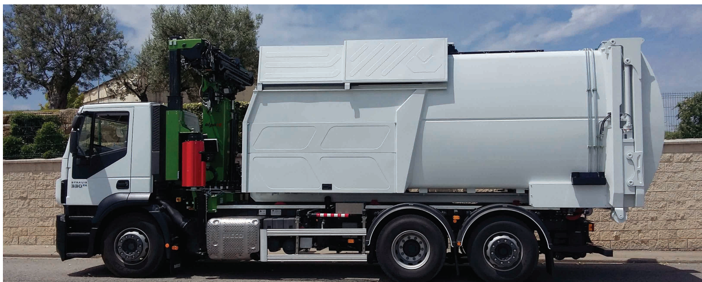
SISTEMA DI COPERTURA MOBILE DEL CASSONE, CON APERTURA E CHIUSURA SINCRONIZZATA IN AUTOMATICO CON L'ELEVATORE
