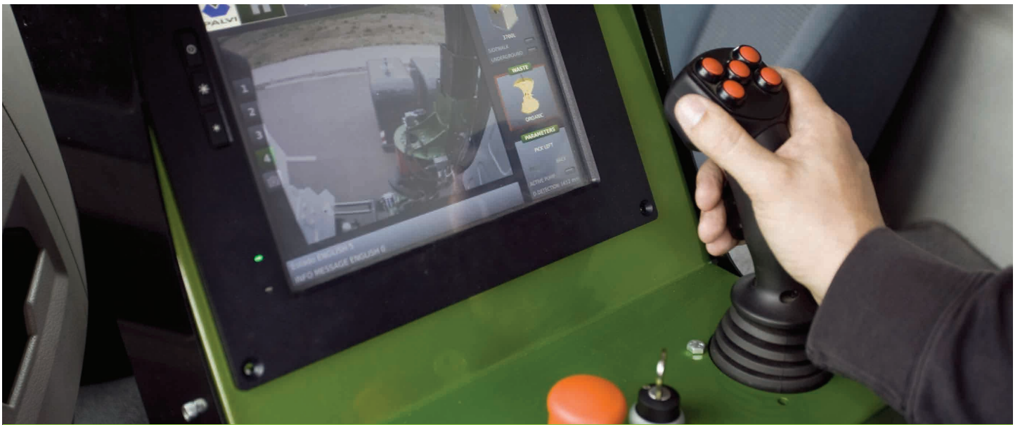
POSTAZIONE DI LAVORO IN CABINA PER OPERARE IN CICLO AUTOMATICO
